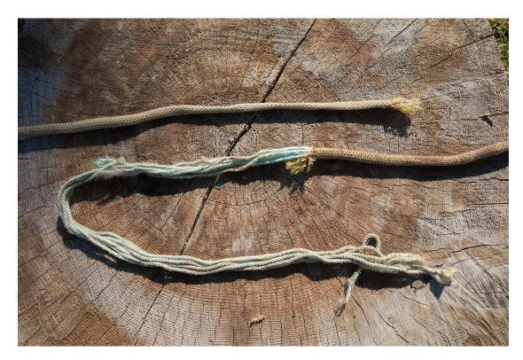
Что это – обрыв или разрезание на острой кромке? Очень похоже на обрыв, но возможно и с частичным повреждением верёвки о края трещины.
